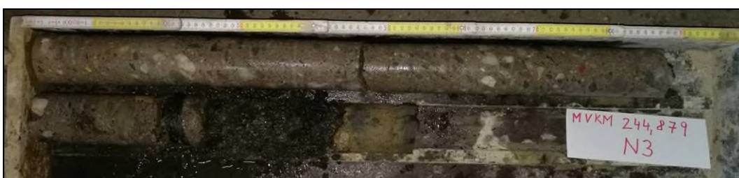
Obr. č. 3 - diagnostický vrt N3 do klenby (mezi kolejemi č. 701 a 702)
