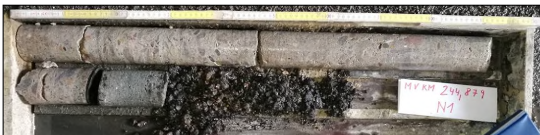
Obr. č. 1 - diagnostický vrt N1 do klenby (vpravo od koleje č. 413a)
